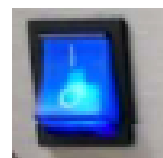
INTERRUPTOR GENERAL ENCENDIDO/APAGADO
