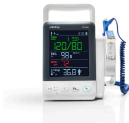
**Seguridad:** Cumple los requisitos de la serie IEC60601. Peso: <1.7 kg con la batería incluida. Pantalla: 90 mm x 99 mm con visualización digital numérica del segmento. Zumbador, que representa el tono de prueba automática de encendido, de pulso y de fallo técnico. NIBP: Modos de funcionamiento: Manual. Unidad de medición: mmHg/kPa seleccionable. Tipos de medición: Sistólica, diastólica, media, frecuencia de pulso
