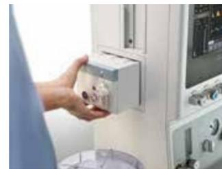
Con un módulo de CO<sub>2</sub> de ranura simple mejorado o con la capacidad del agente anestésico de ranura doble, los módulos multigas tipo Plug-and-Play brindan un análisis exhaustivo de respiración a respiración de FiO<sub>2</sub>, EtO<sub>2</sub>, CO<sub>2</sub>, NO<sub>2</sub> y permiten la autodetección de BIS y de cinco agentes anestésicos.
